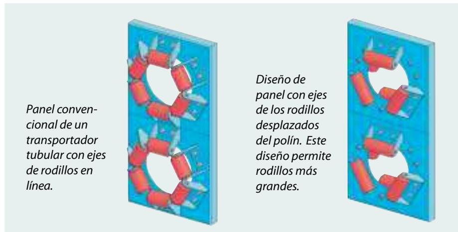
Panel convencional de un transportador tubular con ejes de rodillos en línea.
